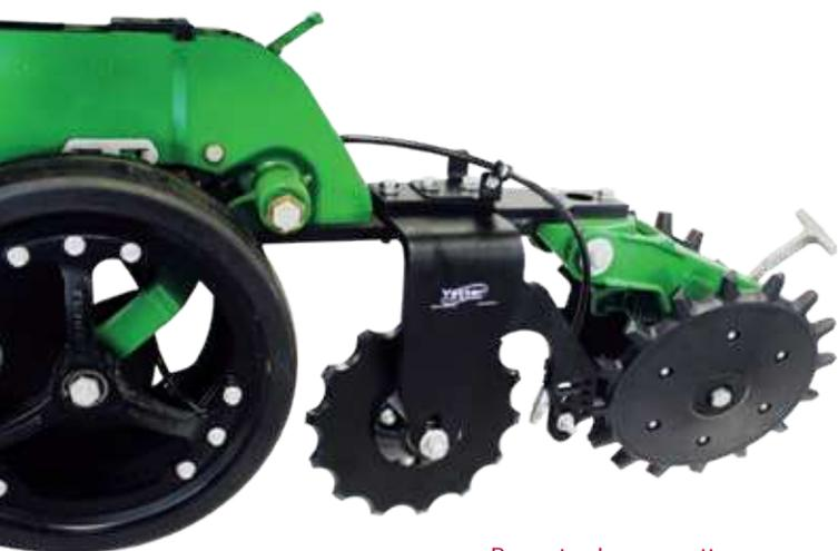
Roue simple avec option de kit d'injection
