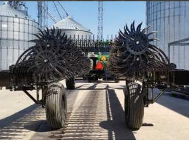
**Yetter 3600 Nachlauf-Rollhacken sind zum Transport einklappbar.**
