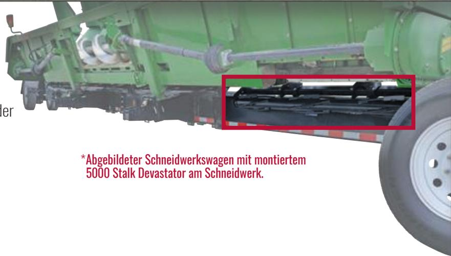
\*Abgebildeter Schneidwerkswagen mit montiertem 5000 Stalk Devastator am Schneidwerk.
